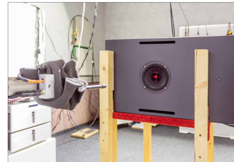
Jeder Lautsprecher wird in der Ansbacher Manufaktur aufgebaut und vor der Auslieferung am Messplatz final überprüft
