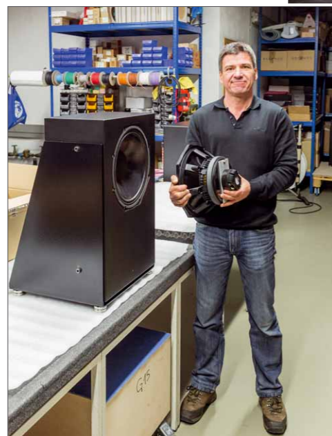
Stefan Köpf mit einem spielfertigen CCRM 12 im Standgehäuse und dem mächtigen 12-Zoll-Treiber in der Hand. Der 18-Sound-Hochtontreiber sitzt huckepack auf dem Magneten auf einer massiven Edelstahlbrücke
